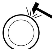
La Porcelaine en pâte renforcée DEGRENNNE contient 50% d'alumine afin d'augmenter sa résistance aux chocs mécaniques.
