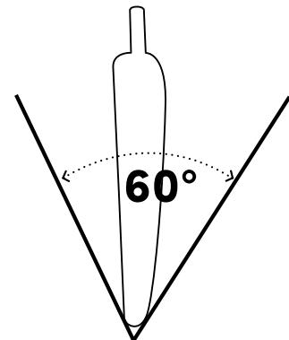
Afin de préserver au maximum la durabilité de la coupe et du tranchant, les lames unies des couteaux DEGRENNNE présentent un angle d'affûtage de 60°.
